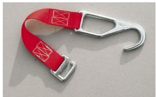
Gurtschlauchhalter nach DIN 14828 Perlongurt mit geschmiedeten Beschlägen
